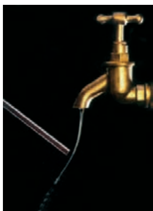
شکل ۱۴- انحراف باریکه آب به وسیله میله شیشه‌ای مالش داده شده به موی سر.
