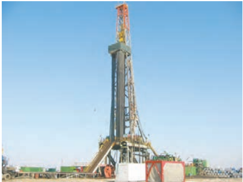
شکل ۱۰- دکل حفاری چاه‌های اکتشافی نفت و گاز
