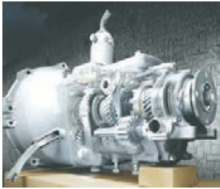
شکل ۱۵ - ترکیب پیچیده‌ای از چرخ‌دنده در جعبه‌دنده خودرو
