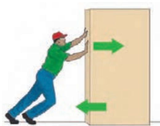
شکل ۲ – شخص به جعبه ساکن نیرو وارد می‌کند ولی جعبه حرکت نمی‌کند زیرا نیروی روبه جلوی شخص با نیروی روبه عقب اصطکاک هم‌اندازه‌اند.
