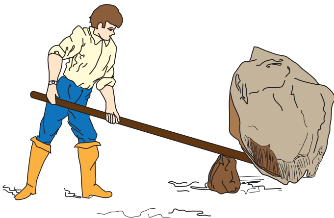
شکل ۴ - مرد با وارد کردن نیروی کوچکی بر دسته اهرم می‌تواند جسم سنگینی را بلند کند.
